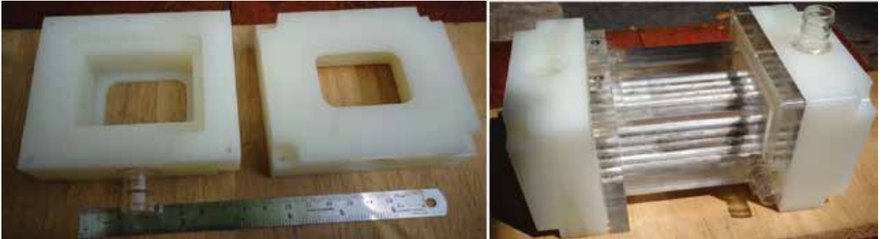
4. एस पी एल के आक्सीजीनेरेटर कार्यक्रम के लिए सूश्मा संचालन के लिए पोलीप्रापयलीन की यांत्रिकी की गई।
