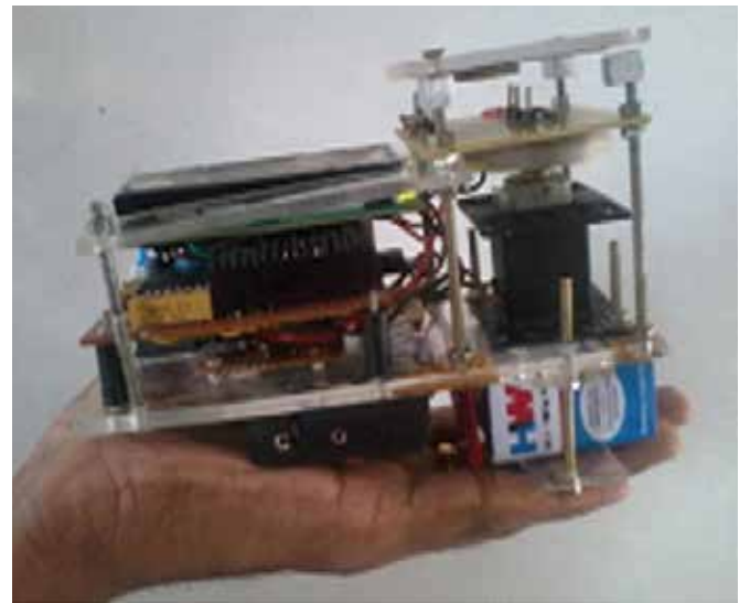
चित्र -पोर्टेबिल इलेक्ट्रोमैग्नेटिक रक्त प्रवाह मीटर का प्रोटोटाइप
